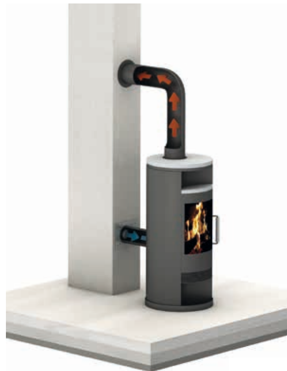
Raumluftunabhängige Schornsteine leiten die Abgase über Dach ab und versorgen die Feuerstätte gleichzeitig mit Verbrennungsluft.
